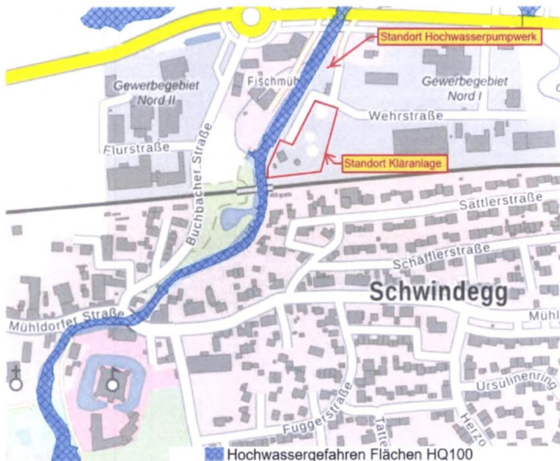
**Abbildung 3:** Standort Kläranlage mit Darstellung der Hochwassergefährdung durch ein HQ<sub>100</sub>
