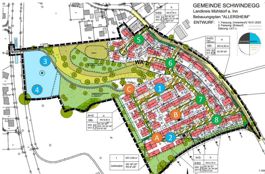
Abb 5: Bodenerkundung mit Kennzeichnung der Bohrpunkte
